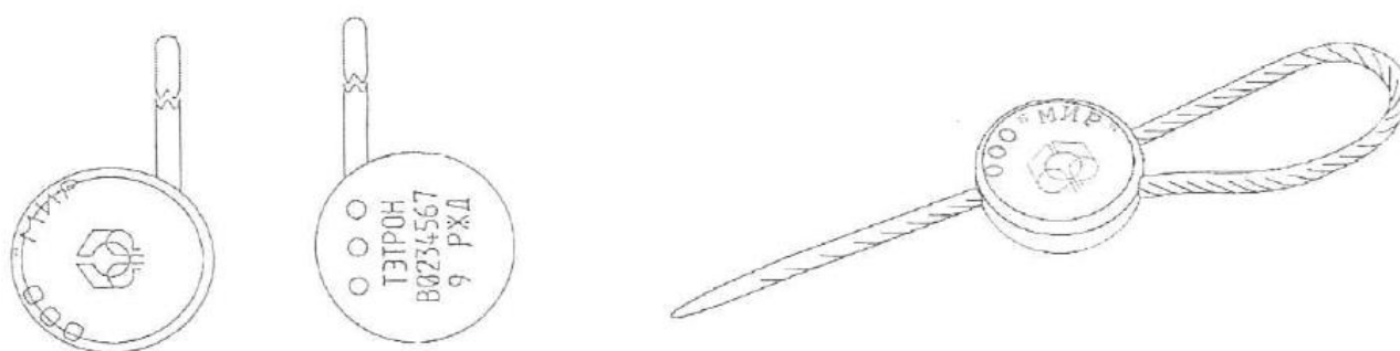
ЗПУ в разомкнутом состоянии
